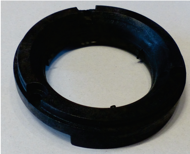
Abbildung 7: Federunterlage im Federbein eines PKW-Fahrwerks
