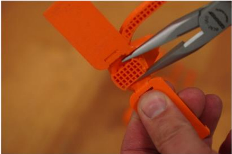
Abbildung 34: Entfernung der Stützstrukturen
