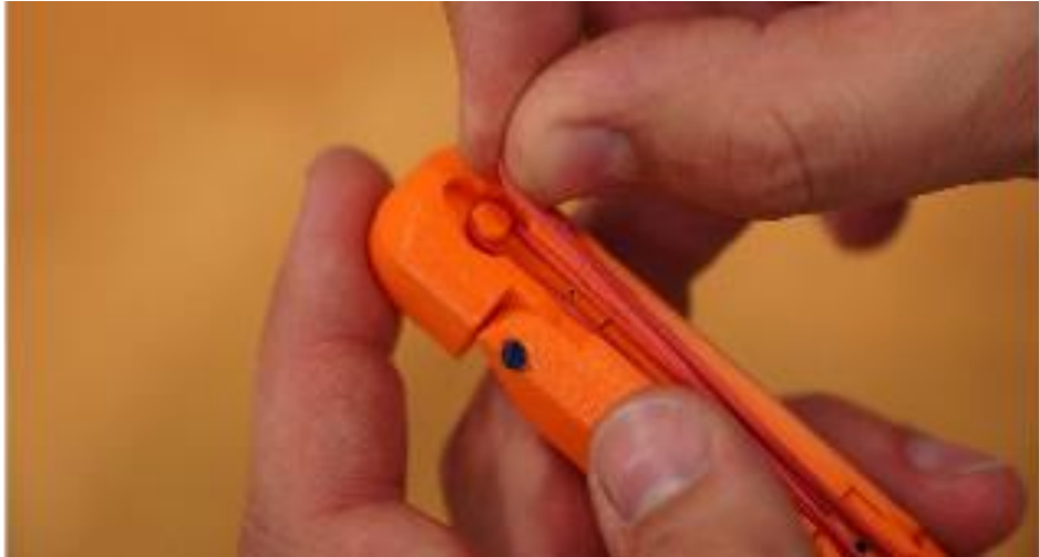
Abbildung 39: Montage des Gummibandes für den Finger
