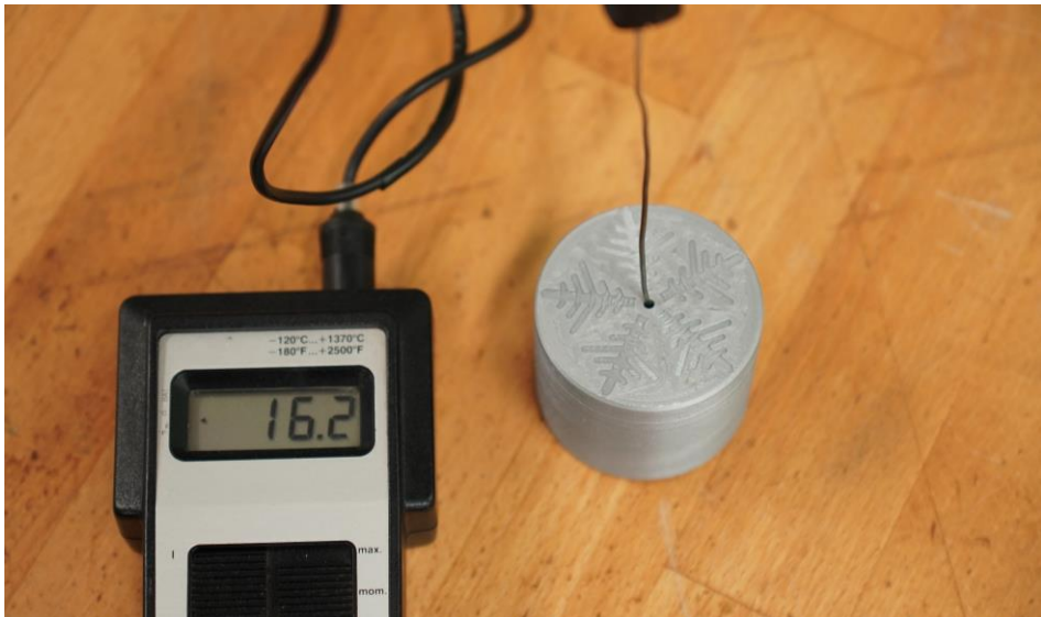
Abbildung 2: Experimentiersetting zur Wärmedämmung
