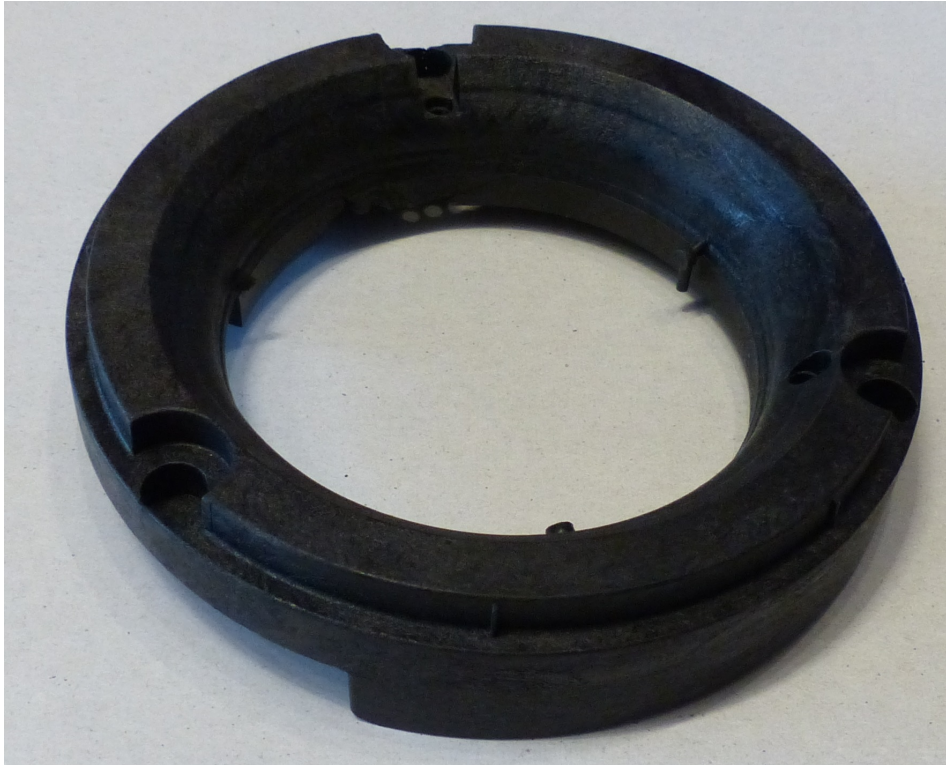
Abbildung 10: Hartkomponente der Federunterlage, hergestellt mit dem SmartFoam-Verfahren
